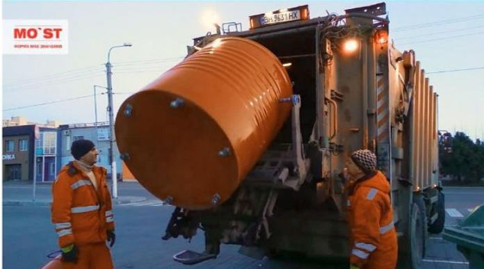
Контейнер модификации «под манипулятор» применяется с использованием кранового оборудования, смонтированного на мусоровозе или на грузовом автомобиле с бортами. Выгрузка данного типа контейнера производится через люки, расположенные в днище контейнера.
